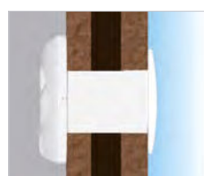
krátké odvodní potrubí
